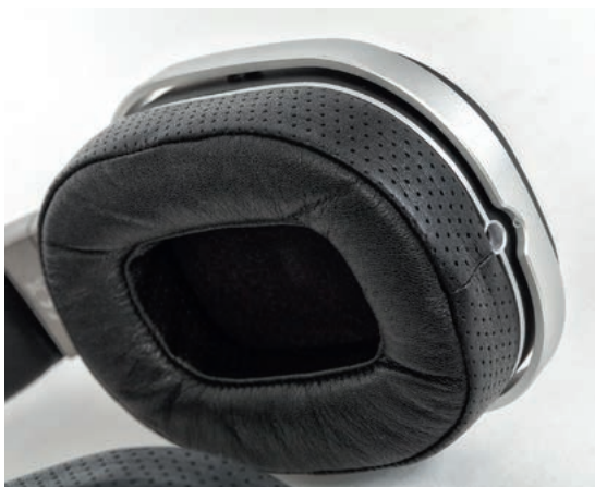
Padły zostały wykonane ze skóry, ucho może jednak "oddychać" przez perforacje na bocznych ściankach. Wewnątrz owalnych muszli znajdują się przetworniki o tym samym kształcie. Z każdej muszli wyprowadzono 2,5-mm gniazdo.
